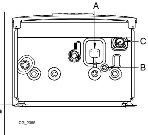
Kotao poseduje hidraulični presostat koji obezbeđuje zaštitu rada kotla ukoliko nema vode u sistemu. Ukoliko pritisak pada često potrebno je da pozovete ovlašćeni servis.
